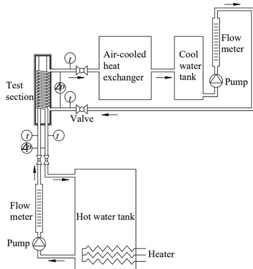
**Fig. 2: Experimental apparatus**
